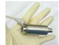
動圧軸受軸流型 国産・産総研・三菱重工・ニプロ (動物実験中)
